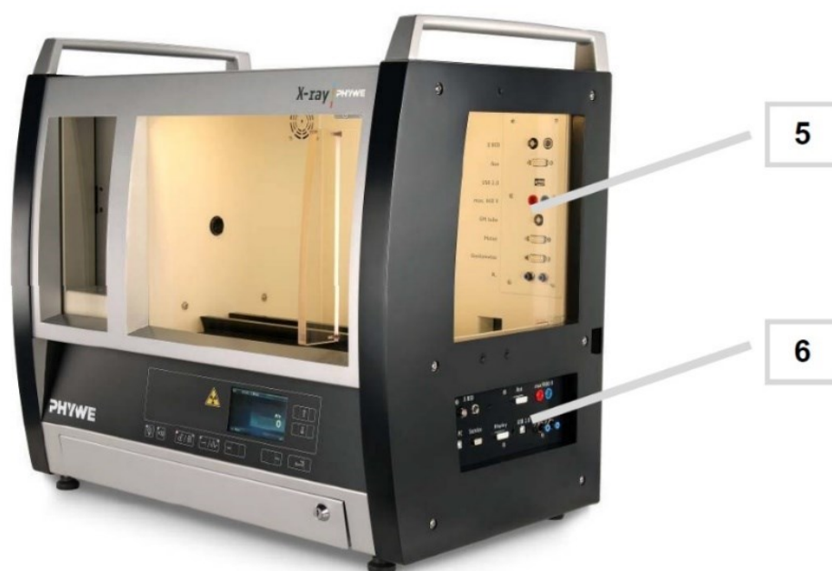
Рис. 2 – Рентгеновская установка XR 4.0, вид справа
